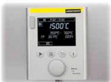
Controller in de ovendeur gehangen en afneembaar voor een comfortabele bediening
